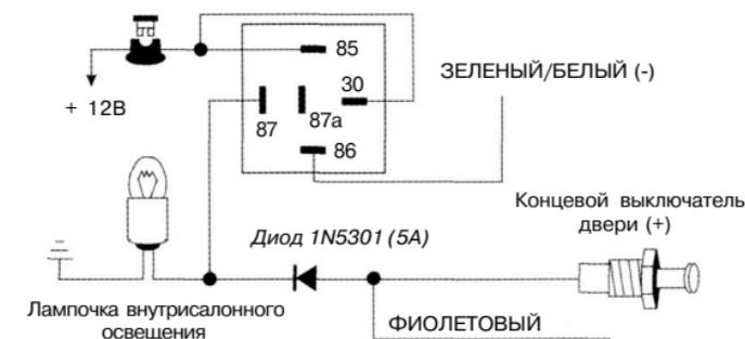
**Внимание! Обязательно** используйте диод для изолирования цепи управления внутри салонным освещением от цепи триггера двери. В противном случае не сможет правильно работать функция автоматической повторной постановки системы в режим охраны.
