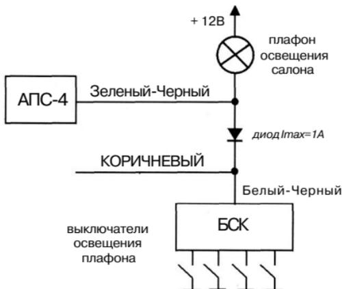
3. Рекомендуемая схема подключения ТЕМНО-ЗЕЛЕННОГО провода системы ("отрицательный триггер капота/багажника") к подкапотной лампе автомобилей ВАЗ семейств 2109, 2115, 2123 или лампе освещения багажника автомобилей ВАЗ семейства 2115:
