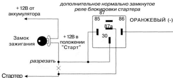
**Подсоединение:** Подсоедините Оранжевый провод к контакту # 86 дополнительного реле. Подсоедините контакт # 85 реле к проводу от замка зажигания, на который поступает напряжение +12В, когда ключ зажигания находится в положении "ЗАПУСК", и присутствует напряжение 0В, когда ключ зажигания находится в положении "ВЫКЛ".
