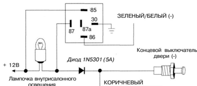
**Подсоединение:** Подключите Зеленый/Белый провод к контакту # 86 дополнительного 30А реле и подсоедините контакт # 85 реле к +12В. Подсоедините остальные контакты реле в соответствии с полярностью цепи внутрисалонного освещения как показано на схемах.
