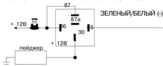
**Подсоединение:** Подсоедините Зеленый/Белый провод к проводу отрицательного триггера дополнительного пейджера. В том случае, если пейджер управляется положительным триггером, используйте дополнительное реле, как показано на схеме.
