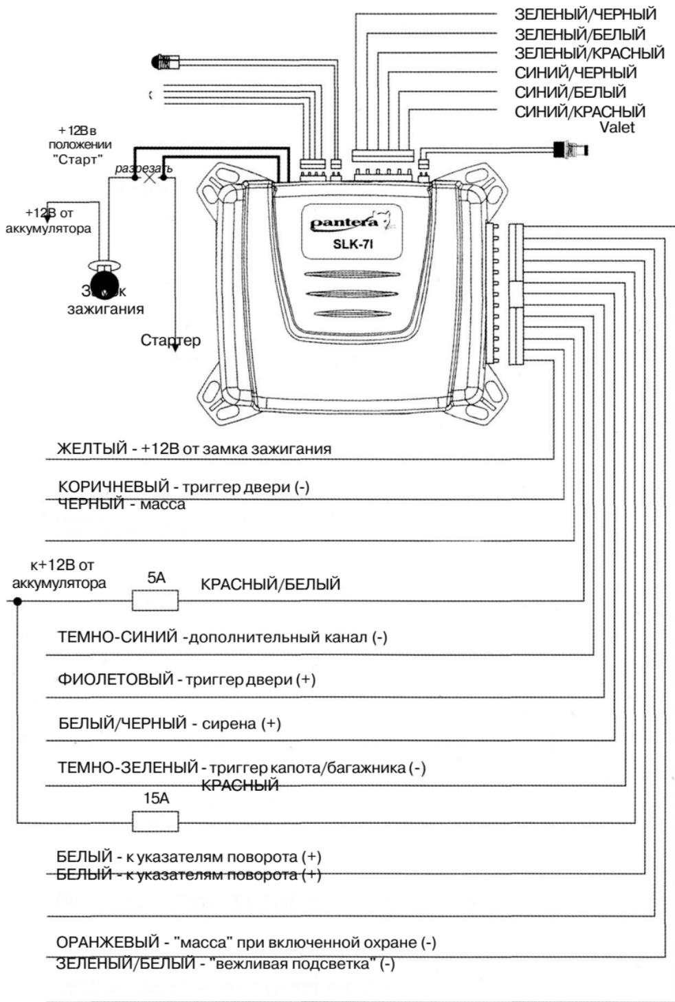
**Схема 1. 3-проводная система с отрицательной полярностью (большинство японских автомобилей)**
