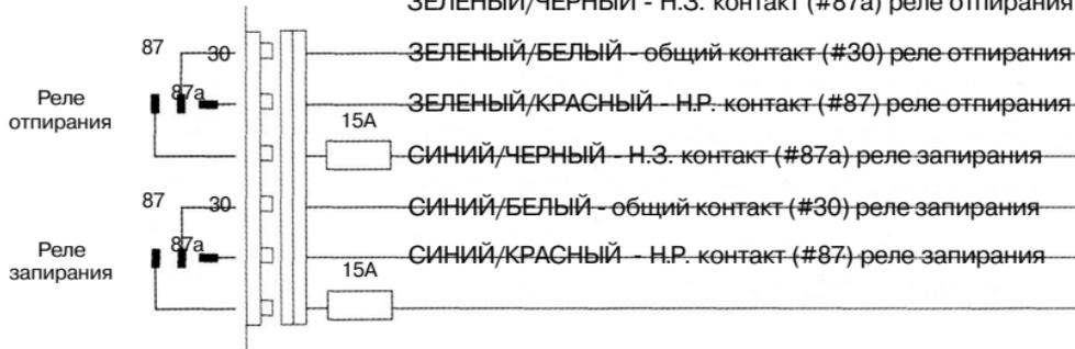
Перед подключением системы к установленным электроприводам замков дверей необходимо определить тип штатной системы центрального замка. Для этого - выньте выключатель дверного замка из панели двери водителя и протестируйте провода, идущие от выключателя.
