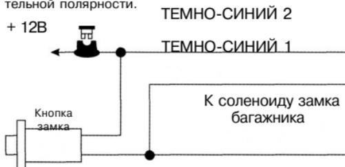
Для дистанционного отпирания замка багажника подсоедините Темно-Синий провод 1 и Темно-Синий провод 2 системы как показано на схеме.
